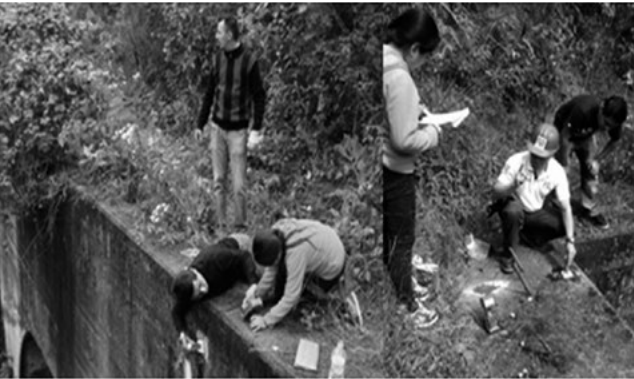
Figura 9. Localización del acero de refuerzo externo, y prueba en el lugar mediante el sensor Cu/CuSO4 y Multímetro de Alta Impedancia
