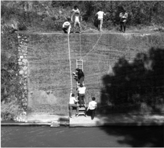
Figura 10. Medición de potenciales en el lugar mediante el sensor Cu/CuSO4 y Multímetro de Alta Impedancia
