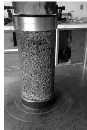
Figura 3. Ensayo a la compresión del cilindro de concreto permeable
