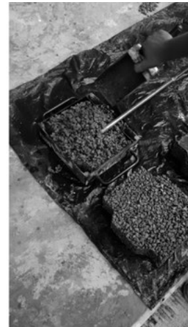
Figura 2. Elaboración de los adoquines con grava de 3/8
