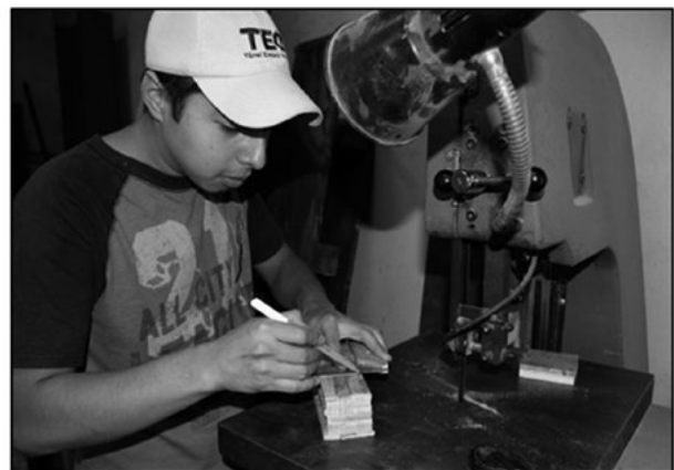
Figura 15. Fabricación de probetas AnLVPa.
