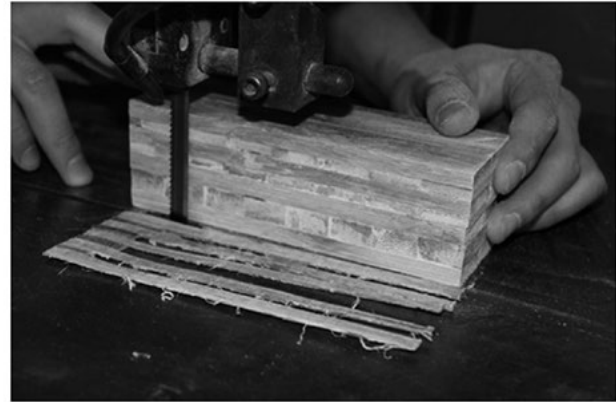
Figura 11. Fabricación de probetas de AnLCPe.
