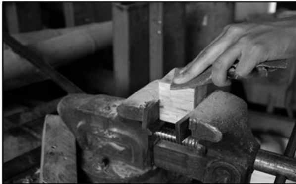
Figura 18. Fabricación de probetas AnLVPe.
