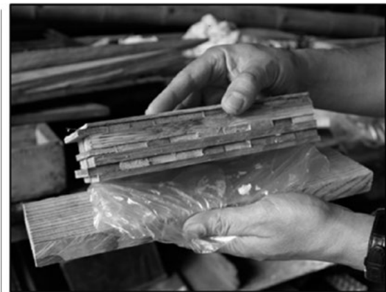
Figura 7. Fabricación de probetas AnLCPa.
