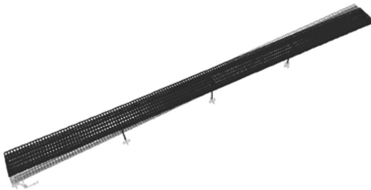
Figura 5. Primer modo del puente regular con apoyos de neopreno en los estribos
