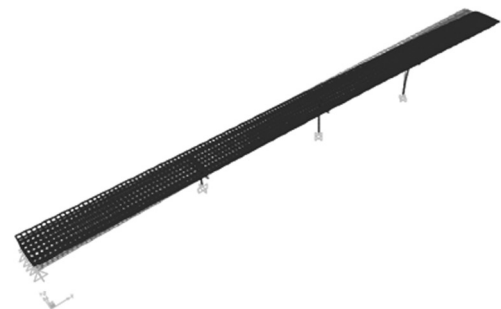
Figura 8. Primer modo del puente irregular con apoyos de neopreno en los extremos
