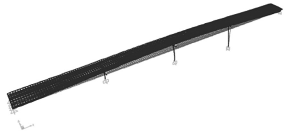
Figura 7. Primer modo del puente irregular con apoyos articulados en los estribos
