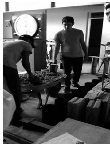
Figura 6. Proceso de llenado en los cilindros. Fuente: Los autores
