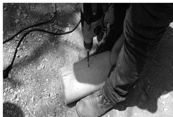
Figura 8. Proceso de perforación de los cilindros. Fuente: los Autores.
