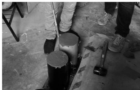
Figura 7. Cilindros terminados y listos para comenzar el secado. Fuente: Los autores.
