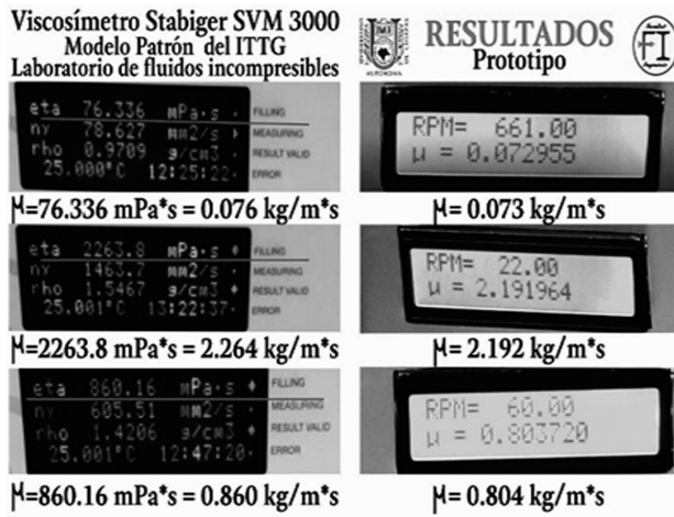
Figura 10. Valores obtenidos con el viscosímetro Stabiger y los obtenidos con el modelo VR.
