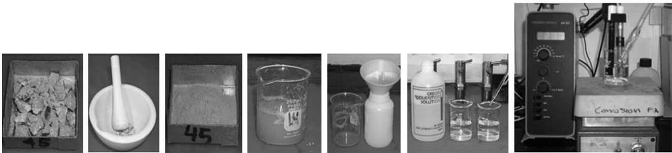
Figura 1. Ilustración del proceso de extracción de iones cloruros y equipos empleados (Autoría propia).
