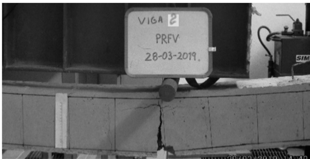
Figura 5. Ruptura de varilla de PRFV 4mm a la falla
