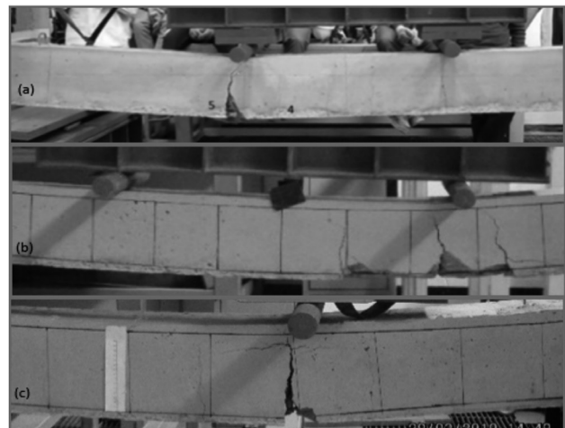
Figura 8. Fallas bajo los apoyos de los tres especímenes (a) V, (b) V1, (c) V2.
