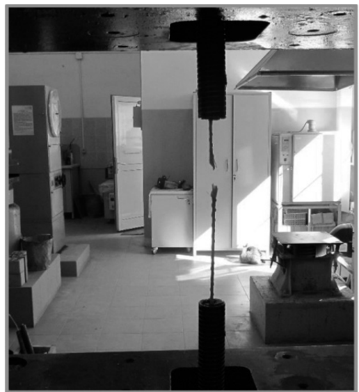
Figura 1. Prueba de tensión de barra de PRFV
