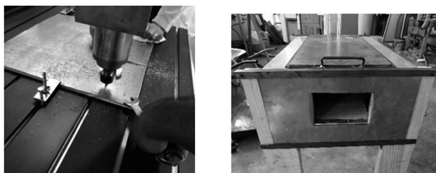
Figura 6. Maquinado en Router CNC de la entrada y salida de la estufa. (Foto Osbaldo Y. García 2019)
