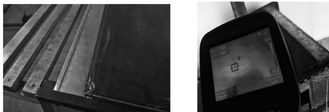
Figura 4. Temperatura en el comal superior a los 500 °C. (Foto Oscar Martínez 2019)
