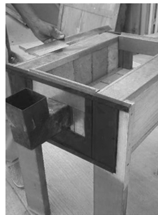
Figura 7. Codo de salida de PTR 3.5 Pulgadas. Foto J. Moreira 2019.
