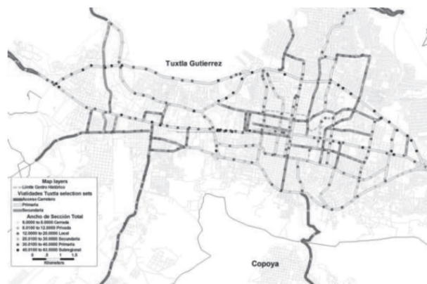
Figura 2. Jerarquía de la Red vial de las ciudades de Tuxtla Gutiérrez, Berriozábal y Chiapa de Corzo. (Gobierno del Estado de Chiapas, 2018)
